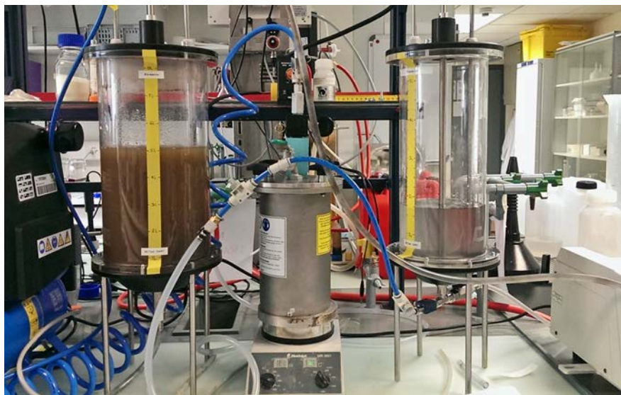
Une station d'épuration miniature a été reconstituée en laboratoire. Les eaux usées y sont traitées en plusieurs étapes.
