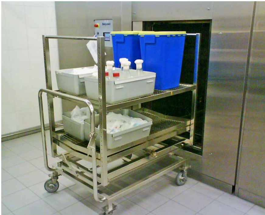
Autoklav zur thermischen Inaktivierung biologisch kontaminierter Abfälle (links), respektive ein modernes Labor (oben).
